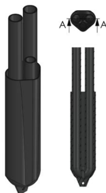
Widok konstrukcji głowicy wymiennika gruntowego (sondy)
